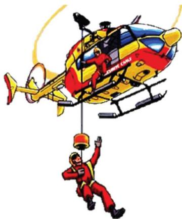
Lorsque l'atterrissage est impossible, il est parfois nécessaire de procéder à un treuillage. Le treuil est dispositif fixé au-dessus de la portière latérale de l'appareil. Il peut se situer soit sur le côté droit, soit sur le côté gauche. D'une longueur d'environ 90 m, il peut supporter une charge d'environ 250 Kg. En fonction du type de sauvetage à réaliser, du matériel supplémentaire pourra être utilisé (un harnais, une barquette...).
